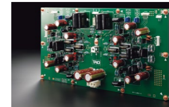
電圧増幅回路 [TAD-M700]
