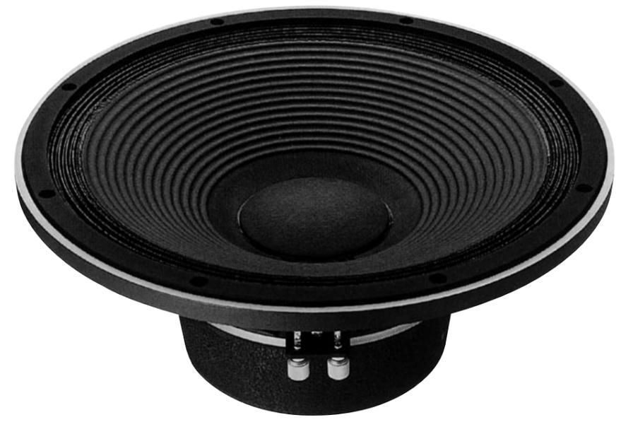
強靱かつ軽量のコーン、特殊ダンプ剤を塗布したコルゲーションタイプ布エッジ、高剛性アルミダイキャストフレームといった、名器TL-1601aによって育まれた資産を継承しつつ、デジタルソース時代のより高いレベルの高耐入力設計を導入したTL-1601b。ボイスコイルボビンに通気孔を設置するとともに、フレームの開口穴と磁気回路の中心穴から強制空冷を行う等の熱対策によって、最大入力値を500Wにまで向上。また、マグネット素材のグレードアップによって、1.24テスラの高磁束密度を獲得。これに、リニアリティに優れた振動支持系とロングボイスコイルを組み合わせることによって出力音圧レベル97.5dBという高感度を達成しています。さらに、信号入力経路には万力タイプの大型端子を装備、入力信号をストレートにボイスコイルに伝達しています。しかもTL-1601aと全く同一の外形寸法とすることで、互換性にも配慮しています。
