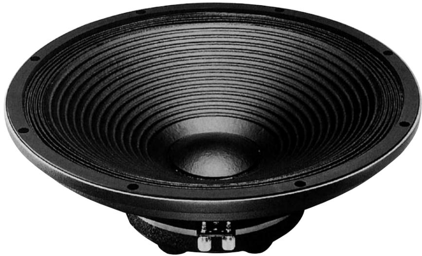
460mmの大口徑ウーファーでありながら、サブウーファー用のみならず2ウェイ使用にも対応しているTL-1801。1.12テスラもの高磁束密度をもつフェライトマグネットを使用した磁気回路と、巻幅23mmの無酸素銅エッジワイズボイスコイルにより、15mmの振幅でも正確な駆動力を維持し、40mmまでは機械的な破損をおこさないほどの高い耐久性をもたせています。この大きなゆとりが大入力時にも力強い再生を実現。最大入力800Wの卓越した能力を誇ります。また、斬新な放熱機構により、長時間の再生にも優れた再現能力を維持。強度の高いアルミダイキャストフレームは7本のアームで磁気回路を支持し、クリアな再生のために入念な共振対策を施しています。また、振動系にはアラミド繊維入りの高剛性のパルプコーンを採用。コーン表面に高分子フィルムをラミネートし、防滴性を確保しコーンの分割振動による音質劣化を排除しています。
