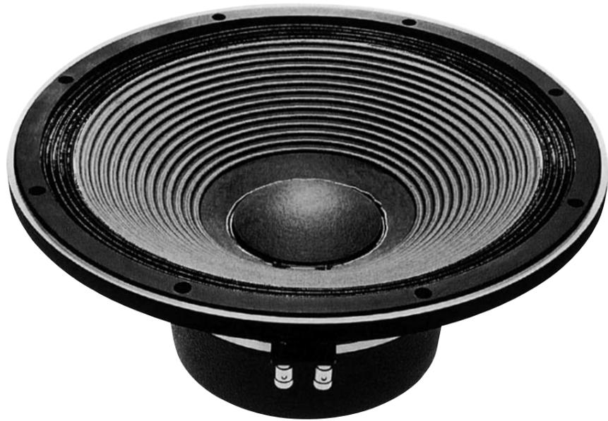
高レベルな出力性能と広帯域・解像能力を誇るウーファー・ユニットがTL-1601aです。磁気回路にはアルニコマグネットを使用。全帯域にわたり発生する歪みを低レベルに抑止。再生時のレスポンス、解像力を大きく左右する振動支持系にも徹底的な検討を加えることで、初動感度や入力対振幅リニアリティも大幅に向上しています。また、プロユースに不可欠な耐久性は、DRS (ダイナミック・レスポンス・サスペンション) 思想を貫き、振動支持系のストロークを十分に設定するとともに、横振れ等のない安定性を確保することで応えています。コーンにおいては自然な響きとなる木質バルブを素材に特殊なエージング処理を施しているため、強靱でしかも劣化がほとんどありません。そのため「振動板の腰が抜ける」といった大入力時における現象も克服しています。さらに、高耐熱性のエッジワイズ・ボイスコイルの採用や、アルミダイキャストフレームと磁気回路自身を放熱器として効果的に利用するなど、長時間の使用にも安定した性能を示します。
